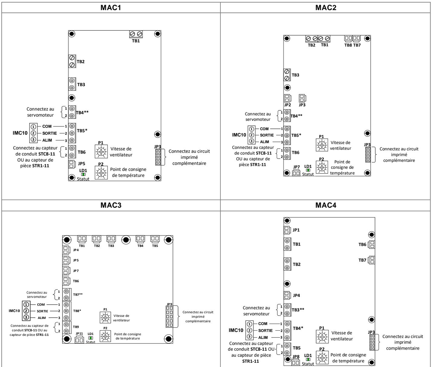
\* Si l'interrupteur de contrôle de pièce IMC10 n'est pas utilisé, placez un cavalier ou un contact sec pour le verrouillage entre les bornes 1 & 2.
