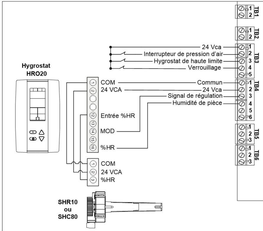
Illustration 40 - Signal de contrôle d'un HRO20 avec un capteur d'humidité à distance (SHR10 ou SHC80)
