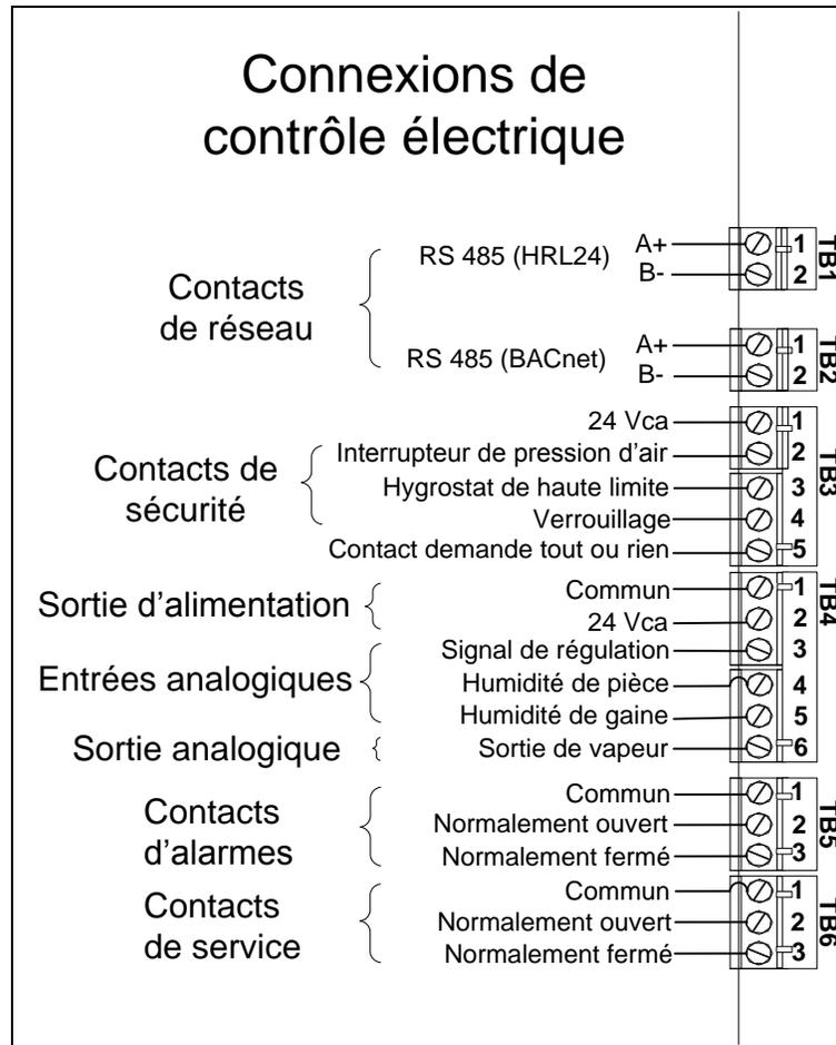
Illustration 36 - Connexions de contrôle électrique
