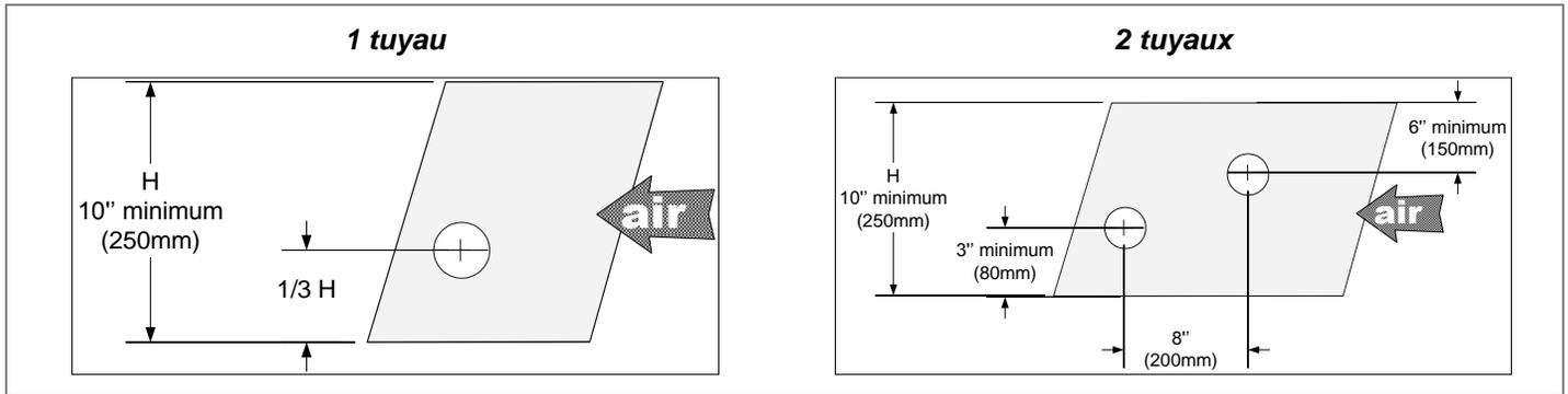
Illustration 18 - Emplacement de tuyaux de 1 3/8" (35 mm) de diamètre : conduit horizontal
