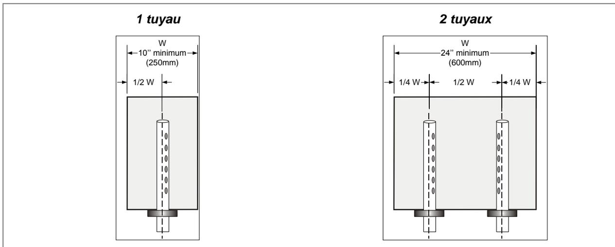
Illustration 21 - Emplacement de tuyaux de 1 3/8" (35 mm) de diamètre : conduit vertical
