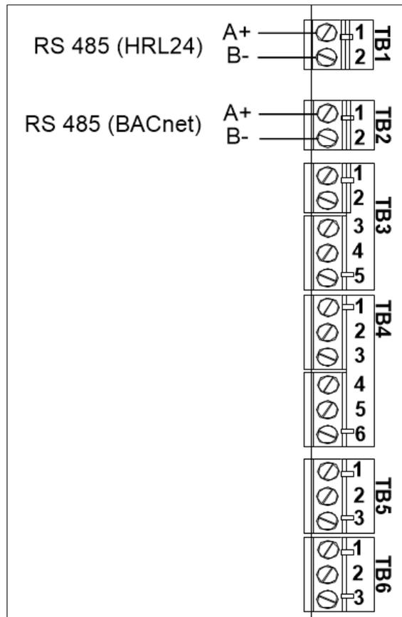
Illustration 42 - Connexions au réseau de communication
