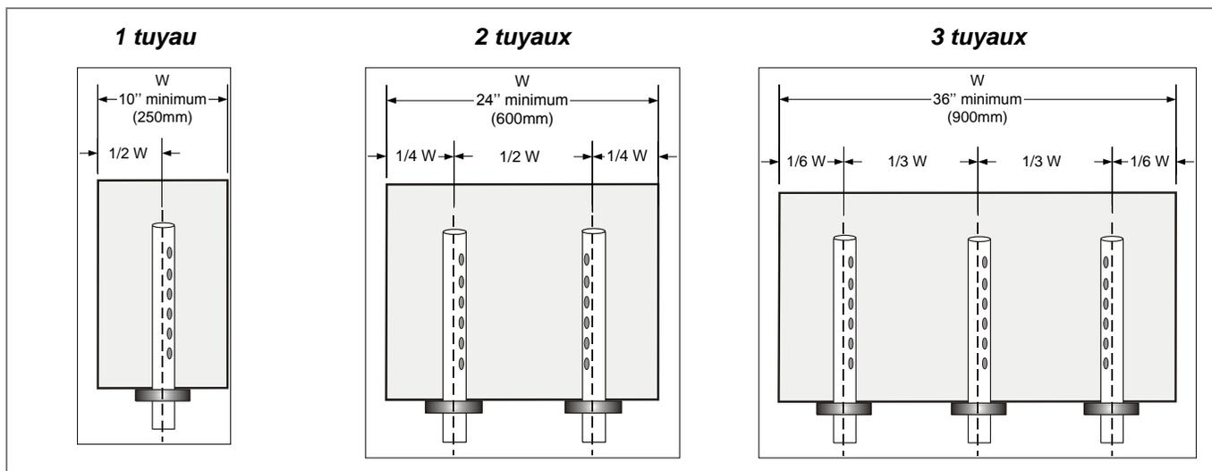
Illustration 22 - Emplacement de tuyaux de 2 1/8" (54 mm) de diamètre : conduit vertical
