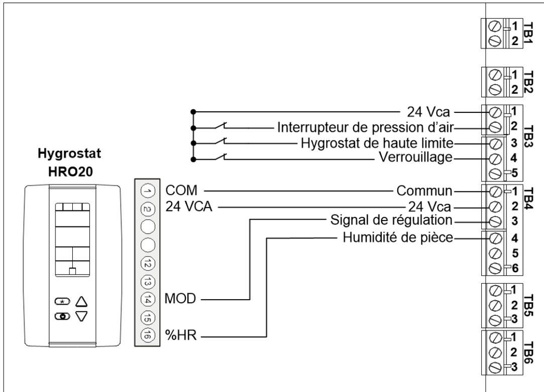
Illustration 39 - Signal de contrôle d'un hygromètre HRO20
