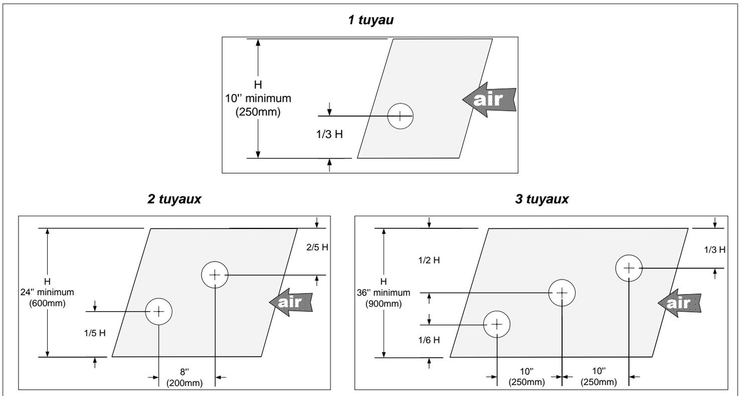
Illustration 19 - Emplacement de tuyaux de 2 1/8" (54 mm) de diamètre : conduit horizontal
