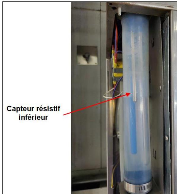
**Étape 5.** La sonde de niveau d'eau va ensuite commencer à se remplir jusqu'à temps que le niveau atteint le capteur résistif supérieur. L'opération de remplissage automatique peut être arrêtée à n'importe quel moment en appuyant et maintenant sur Enter ✓ pendant 3 secondes.
