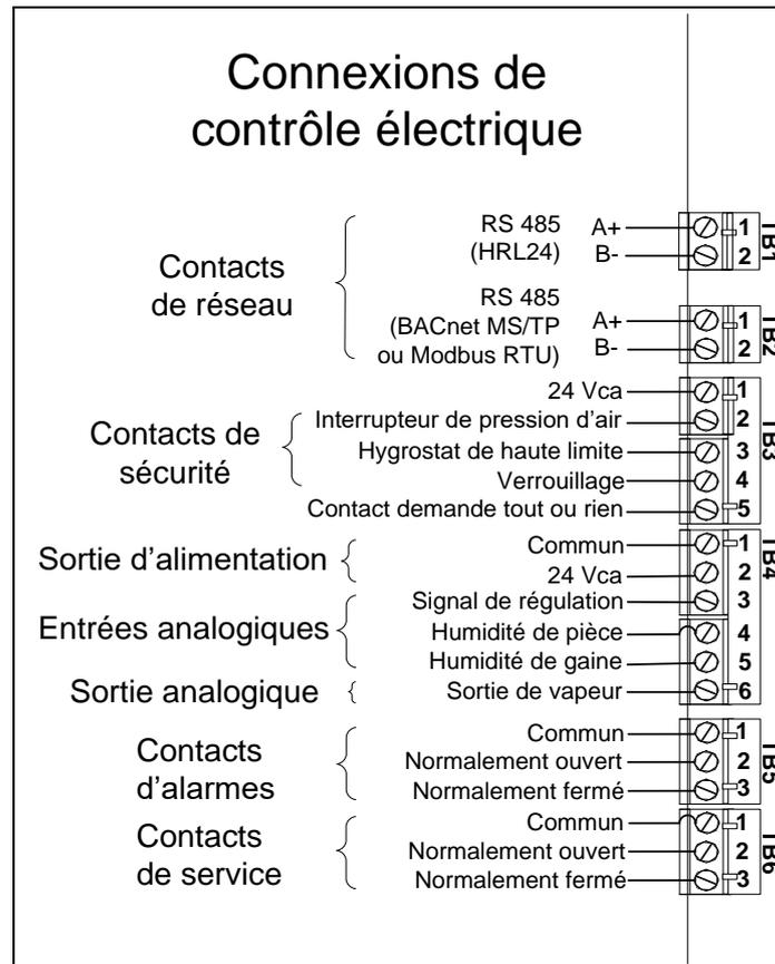
Illustration 39 - Connexions de contrôle électrique
