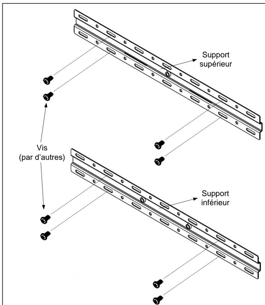
Illustration 8 - Fixation des supports de montage
