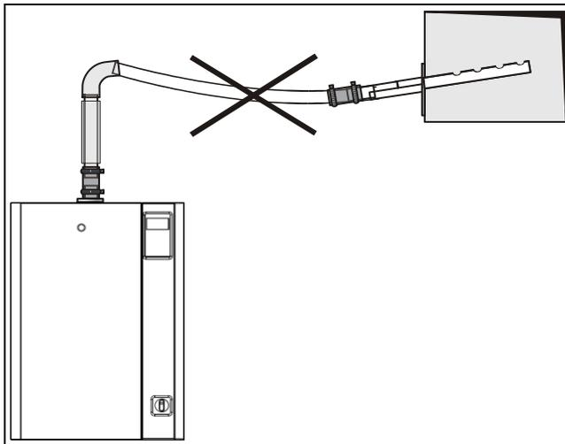
Illustration 24 - Installation erronée de la sortie de vapeur
