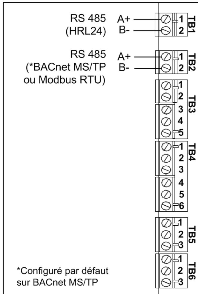
Illustration 46 - Connexions au réseau de communication
