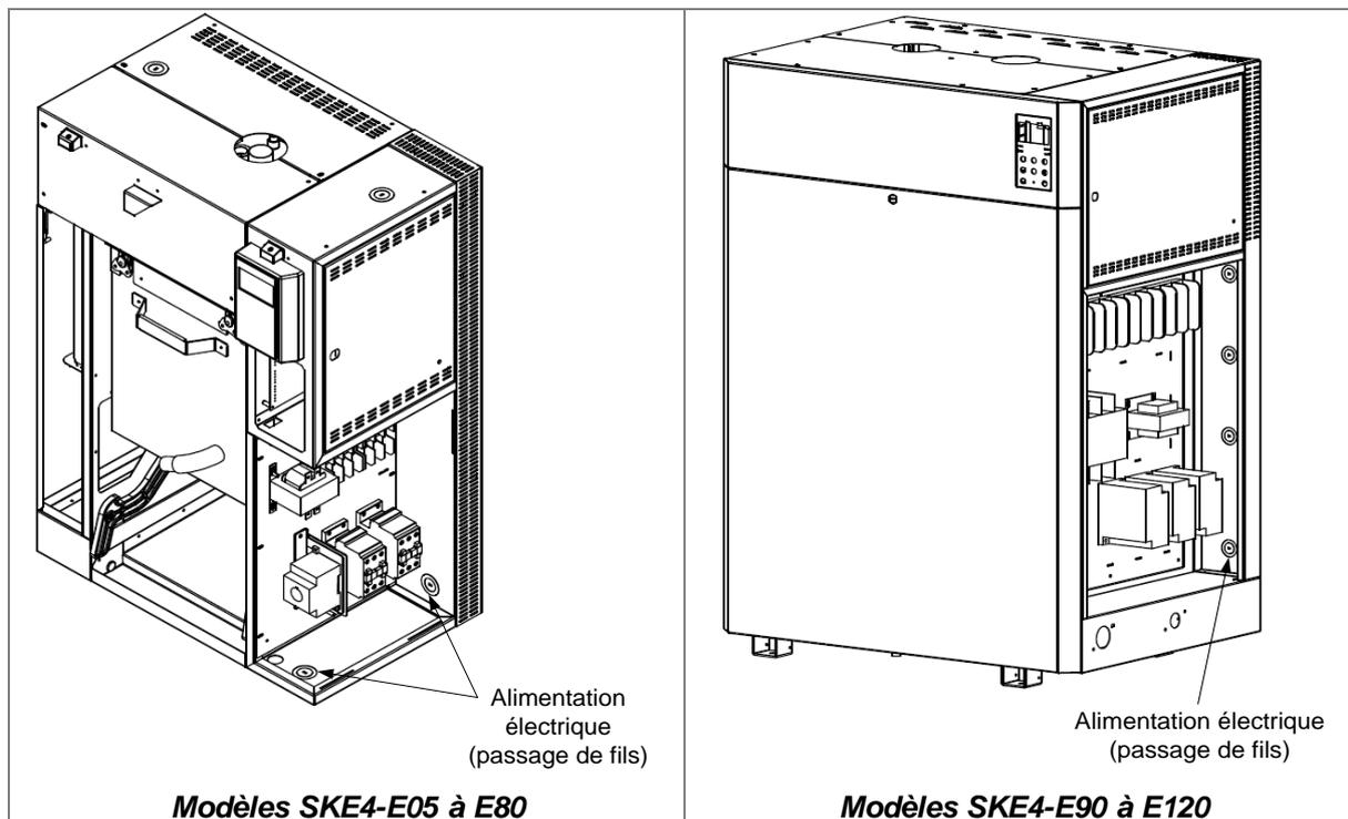
Illustration 36 - Trous pour alimentation électrique (humidificateur standard)
